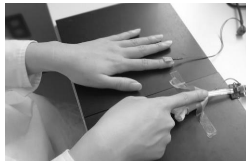
図 1. 本実験で使用された実験装置。参加者が右手人さし指で指サックを押下すると、両手人さし指のモーターが振動する。
