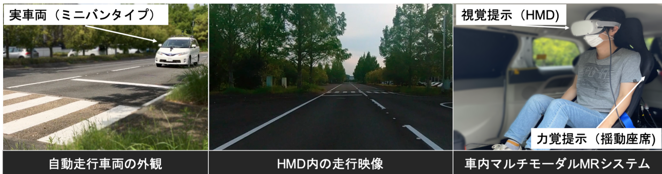
図 1: マルチモーダル MR システムの概要 (自動走行車両 (左), 搭乗者が見ている HMD 内の走行映像 (真ん中), 視覚・力覚提示が可能な車内 MR システム (右))
