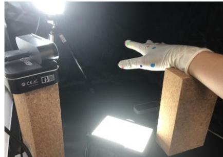
図6: Leap Motionによる測定の様子
