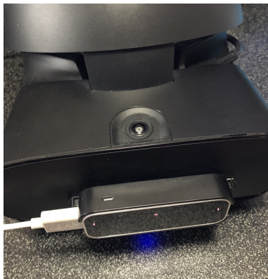
図 1: LeapMotion を装着した OculusRiftS
