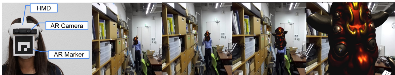
図 1: システム概要とユーザーの視覚体験。本システムは AR カメラと AR マーカーを搭載した HMD から構成される (左)。右側の一連の図は、投影された仮面がどのように見えるかを表す。仮面は、十分に離れているときは相手の顔に追従し、近づくと観察者に向かって加速する。
