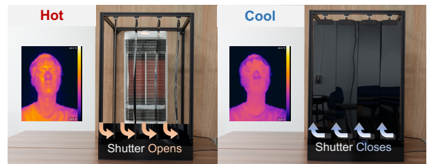
図1: フィンを回転させることで赤外線が通過する隙間幅を変化させ、非接触で応答性の高い温度提示を行う。
