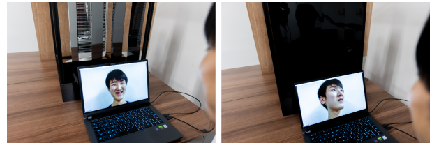
図2: 提案システムでは、相手が自分に視線を向けるほどフィンの隙間幅が大きくなり、強い温度提示を受ける。
