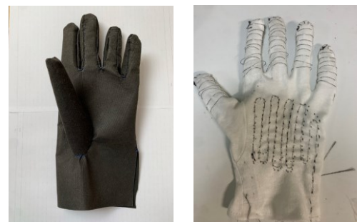
図 5 (左) センサグローブの感圧部と (右) 電極部
