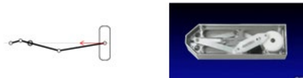
図 4:牽引力錯覚の原理と牽引装置
