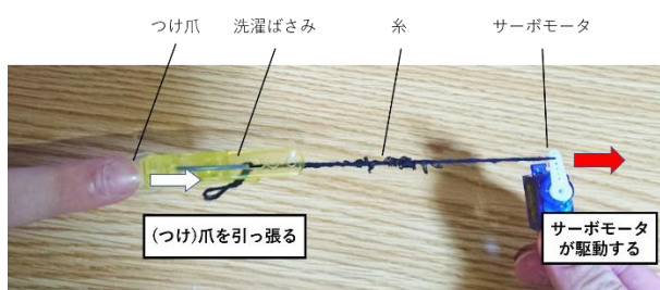
図 7 サーボモータによる(つけ)爪を引っ張る機構例
