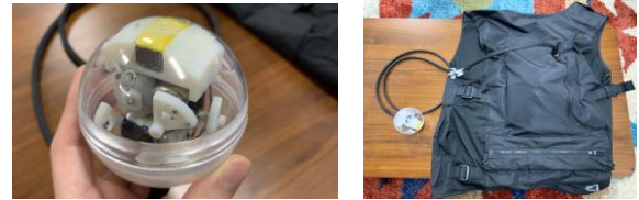
図 2: (左) 球状触覚デバイス外観 (右) 実装の様子
