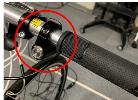
図 2: ボタンとボタンの取り付け位置（右ハンドル）。赤丸で囲った中の銀色の丸い部分がボタンである。
