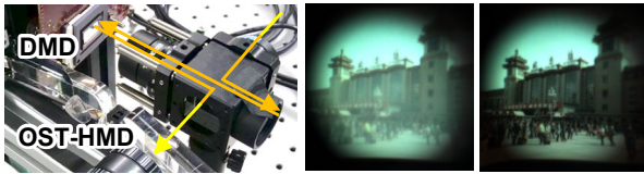
図 5: 光線の空間振幅変調に基づく煙霧除去 [8]。(左) システム構成、(中) 煙霧による視界不良の状態、(右) システムによる煙霧除去後の視界
