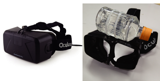
図 4: Oculus Rift DK2(左) と視野制限眼鏡 (右)
