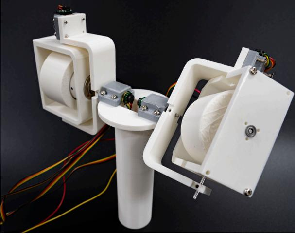
図 2: ジャイロモーメント発生装置のプロトタイプ
