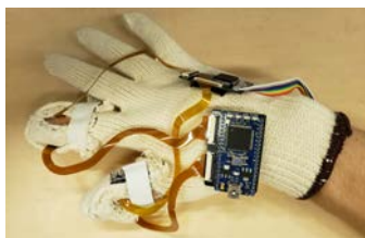
図 2: 手袋型電子的触覚透過システム装着図
