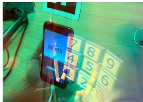
図 1: 実験の様子。被験者はスマートフォンに表示された数字を AR テンキーを用いて入力する。押されたボタンは青色から赤色に変化する。
