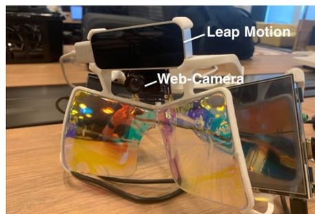
図 2: North Star (AR-HMD)。上部には Leap Motion と web カメラが装着されている
