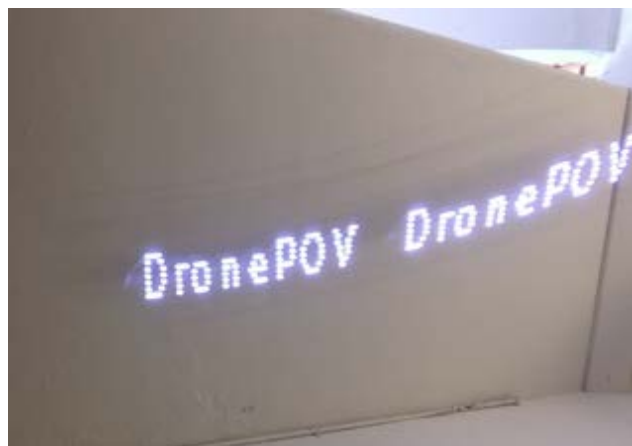
図 7: 屋内での飛行実験 撮影はカメラを垂直上方向に向けて固定し、シャッター速度を落として撮影した
