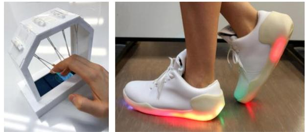
図 2: タッチパネルを利用した指の運動バージョン(左)とスマートシューズを利用した足の運動バージョン(右)
