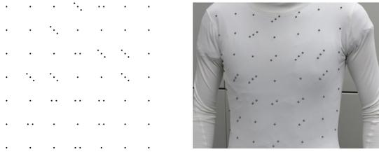
図 1: 本手法で用いたマーカパターン (左) と, それを T シャツに貼付した例 (右). 数点のドットの集合体 (ドットクラスタ) を格子状に配置した構造をとる
