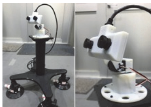
図 6: パンチルト雲台とステレオカメラ
