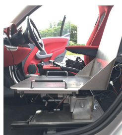
図 3: 2 軸モーションベースを助手席へ取り付けた様子
