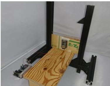
図 1 開発した機械刺激装置
