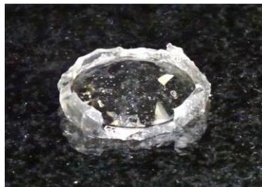
図 1: 寒天を用いて作製した平凸レンズ
