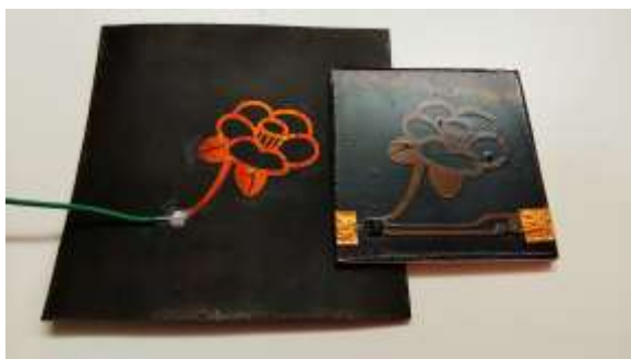
図8：既存手法との見た目の比較(左：金属箔，右：導電性銀ペースト)
