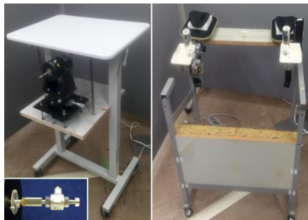
図 1：実験装置（左 加振器，右 手首固定部）
