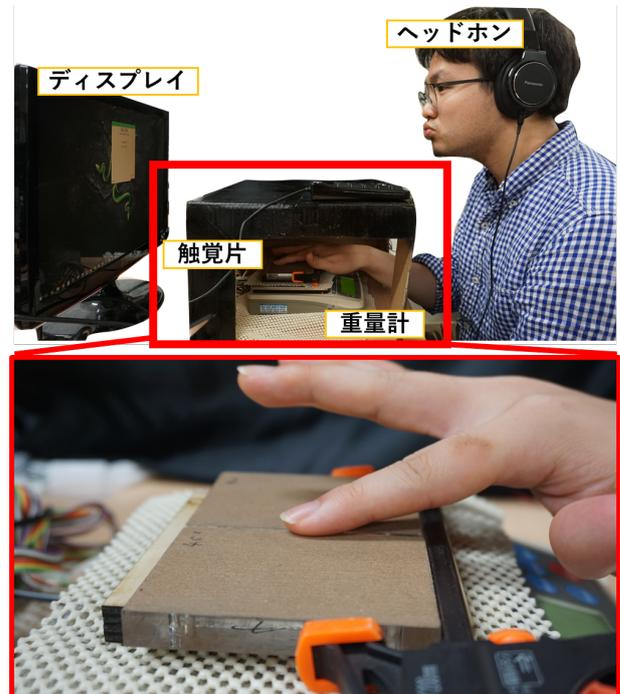
図 3: (上) 実験装置概要図。クランプにて挟み込んだ触覚片を重量計の上でなぞる。(下) 触覚片拡大図。
