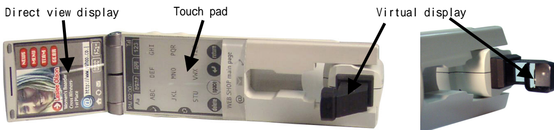
図5 虚像系 VGA ディスプレイ搭載多機能携帯電話の試作機
